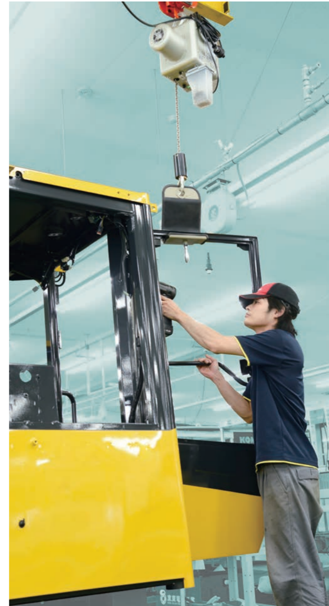
20 kg 문 설치 작업
